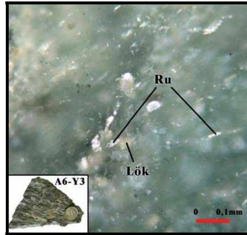
Şekil 32: Killi yan kayaç içinde rutiller (Ru) ve etrafında lökoksensleşmeler (Lök).
